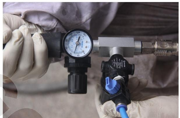
После этого нажав на клапан сброса давления (кнопка желтого цвета, за рукояткой оборудования), верните поршни в исходное положение. Затем, снова нажмите на ‘триггер’, переместите поршни до упора вперед и, снова, нажав на клапан сброса давления, верните поршни в исходное положение, тем самым, проверьте работоспособность распылительного оборудования.
