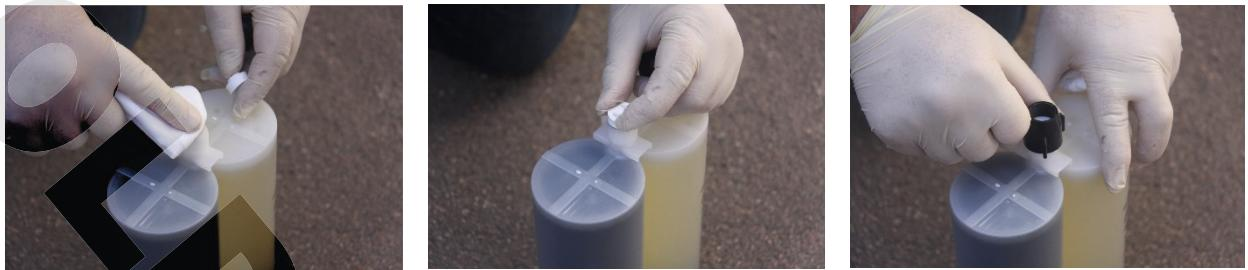
Если, после распыления, эластомерный материал в картридже оказался еще не полностью израсходован, направьте картриджную распылительную систему соплом вниз, отпустите триггер, нажмите на клапан сброса давления, после чего, вытащите картридж, отсоедините статический смеситель, протрите верхнюю часть штуцера картриджа, после чего, аккуратно переверните картридж в вертикальное положение, вставьте в штуцер картриджа защитную пробку и плотно прикрутите пластиковый колпачок.
