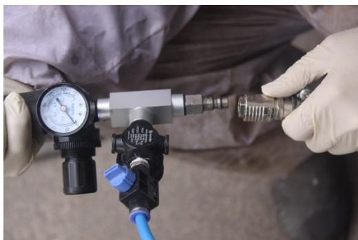
С помощью быстросъемного соединения ('мама'), установленном на воздушном шланге и соединенным с источником сжатого воздуха (компрессором), обеспечьте подсоединение с быстросъемным соединением ('папа'), установленном на металлическом тройнике-распределителе, соединенным, через блок 'манометр - регулятор давления', с картриджной распылительной системой.
